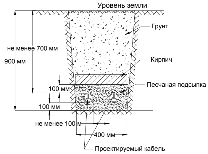
28. Эскиз прокладки кабелей в траншее
