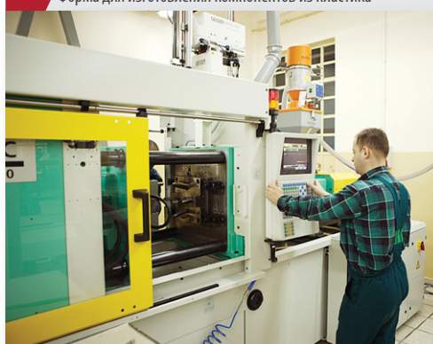
Форма для изготовления компонентов из пластика
