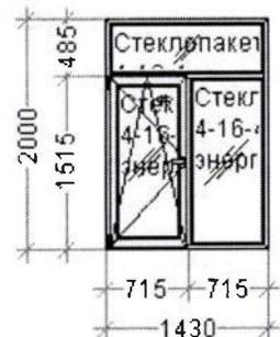
3. Конструкция размером 1430 мм\*2000 мм:
